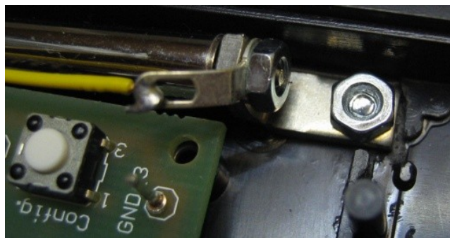
Bild 3: Montage des Eckwinkels bei 122 mm Teleskopantenne
